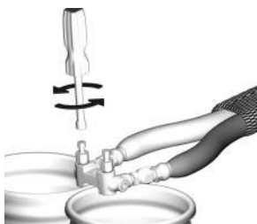
Le collecteur du pistolet pulvérisateur Fusion AP est illustré.
